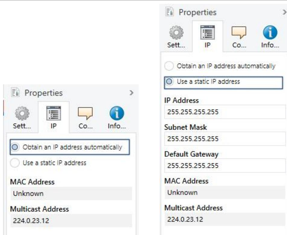
**Obtain an IP address automatically:** 自动获取 IP 地址。在默认设置中，KNX IP 路由器由 DHCP 服务器分配 IP 地址。该服务器通过为设备分配一个空闲 IP 地址来响应请求。如果网络中没有 DHCP 服务器，设备将无法访问。
