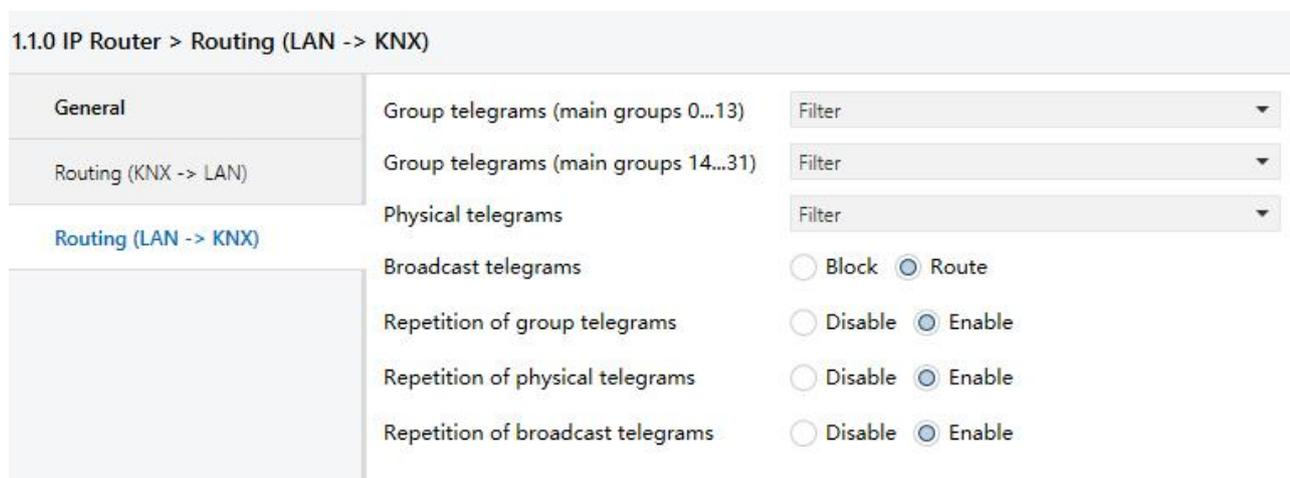
图 5.3 “Routing(LAN->KNX)”参数设置界面
